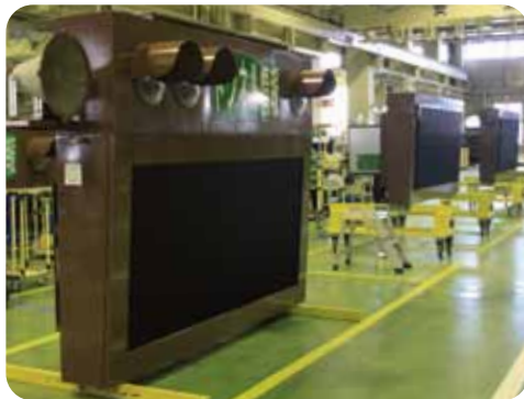
トンネル警報表示板
