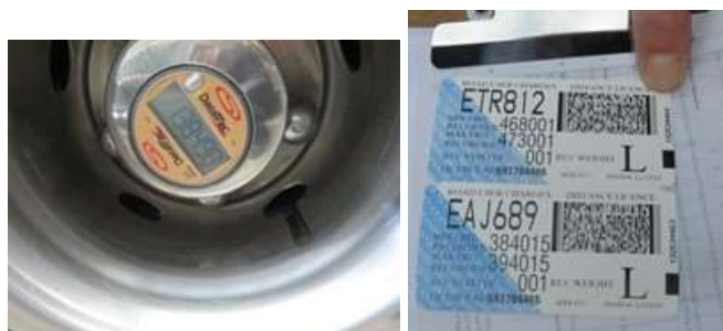
図 2-54 走行距離記録装置(Hubodometer)と RUC ライセンス
