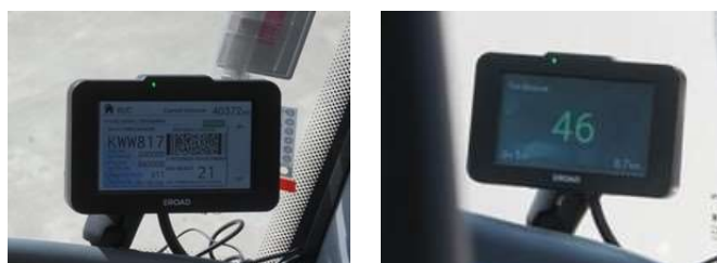
図 2-57 車載器の RUC ライセンス表示と速度表示
