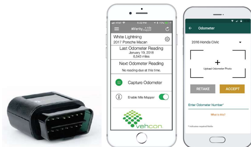
図 2-8 プラグイン車載器（左）とスマートフォンアプリ（右）
