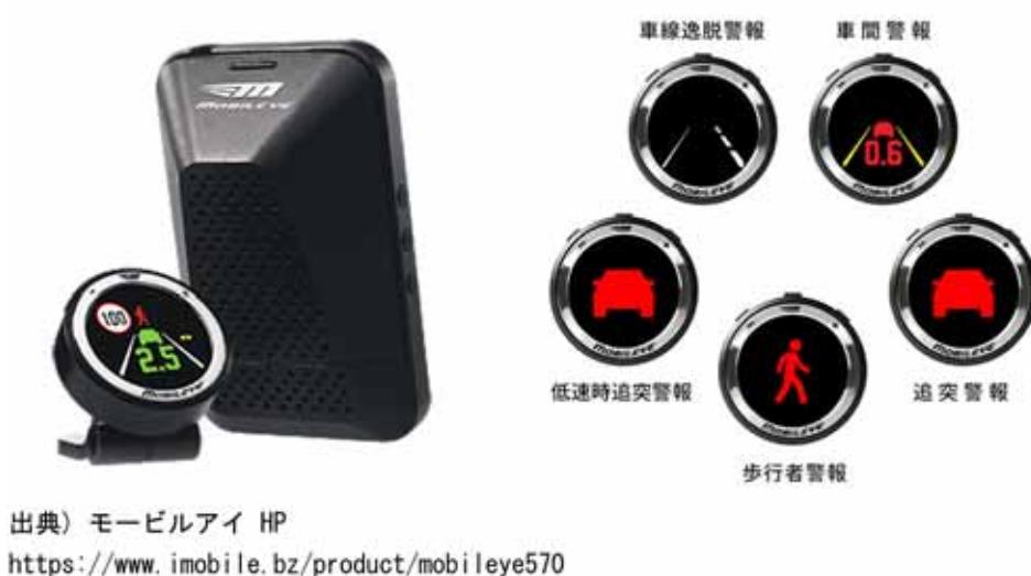
図 2-27 眠気に関する運転挙動を検知する技術の一例(モービルアイ)
