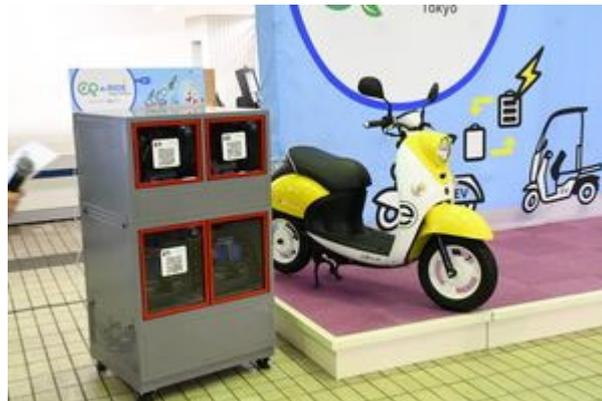
図2.4.15 交換スポットボックスとEVバイク
