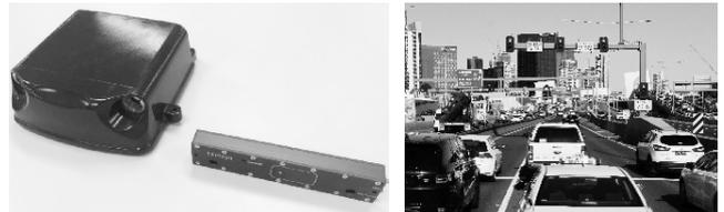
写真一5 車両検知器（左）・ランプメータリング（右）
