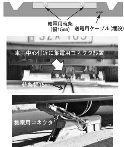
写真一6 走行中給電システム
