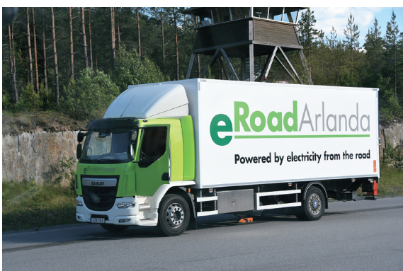
写真七 走行中給電システムを搭載した試験車両 (ストックホルム近郊 Arlanda 地区)
