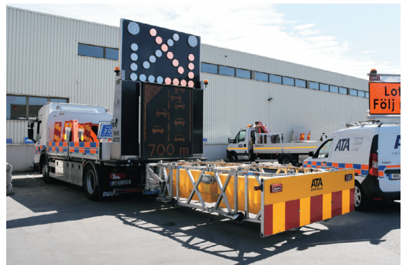
写真四 アルミ製ボックスを使用した衝突緩衝装置
