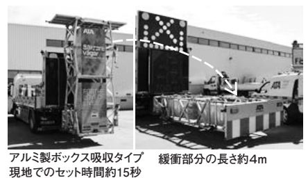
写真一 3 アルミ製ボックスを使用した衝突緩衝装置
