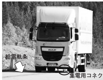
写真一5 実験場での走行中給電試験
