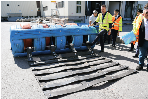
写真三 古タイヤを使用した衝突緩衝装置
