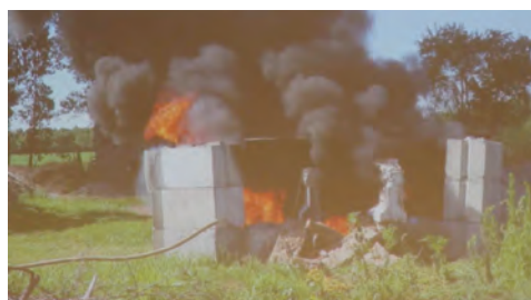
写真1 コンクリート桁火災試験
