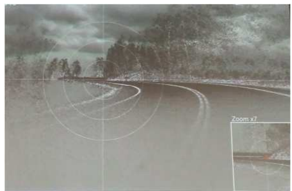
写真 2-2-7 3D モデル上での視距の確認
