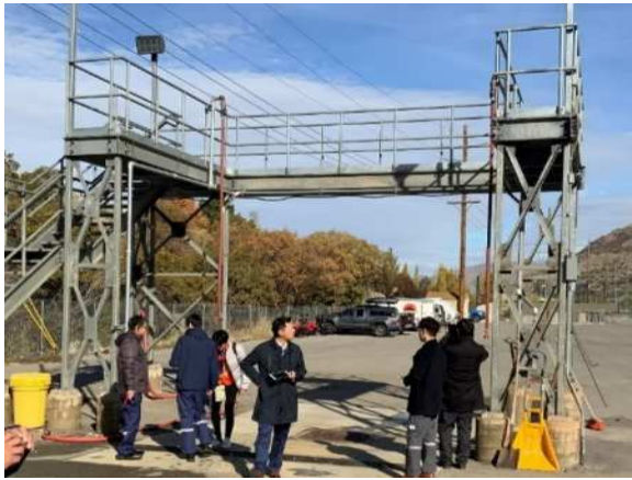
写真 2-4-4 車両洗淨装置(下部洗淨付き)
