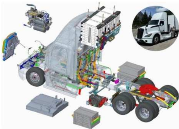
図 2-5-3 1MW 無線充電器搭載のトラック
