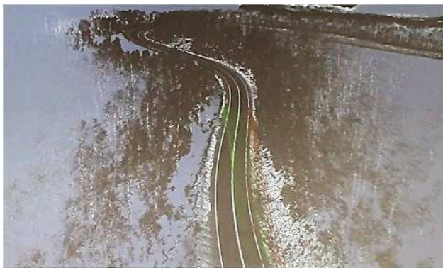
写真 2-2-6 LiDAR により 3D モデル化された道路
