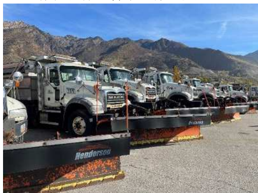
写真 2-4-2 雪氷基地に配備された除雪車
