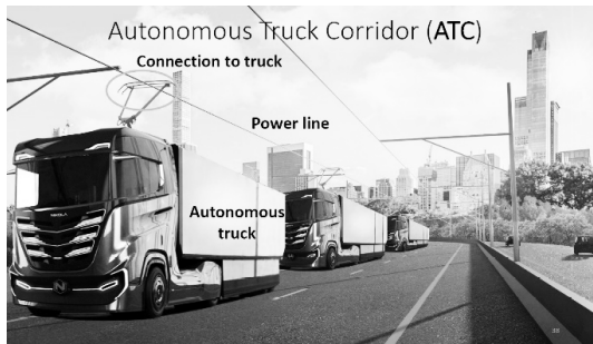
写真-4 トラック自動隊列走行コリドールの電化
