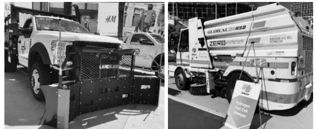
写真—18 (左) 落下物回収機 J-TECH Lane Blade (右) 水素燃料電池式路面清掃車 Global M4
