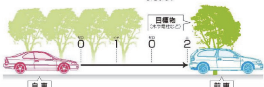
図 6-6 埼玉県警察「ゆとり車間距離 0102 運動の推進」より 2 秒の測り方 22)
