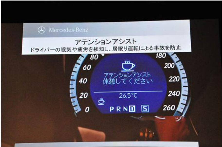
図 2-10(2) 居眠り防止に関する車両設備の事例
