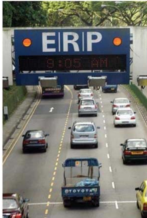
図 1-7 電子的道路課金(ERP)のガントリーの下を通過する交通(シンガポール)
