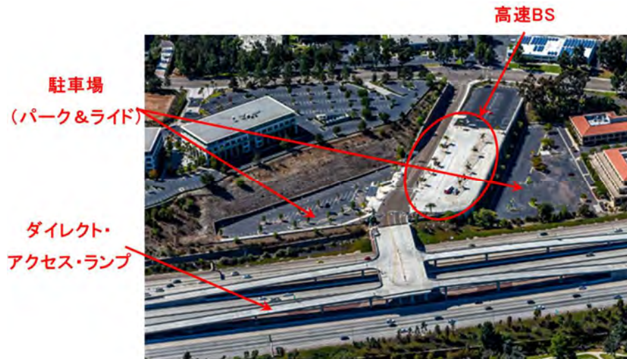
図2.3.3 ランチョ・ベルナルド・トランジット・ステーション
