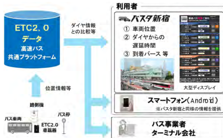
図2.2.11 ETC 高速バスロケシステムの概要 25)
