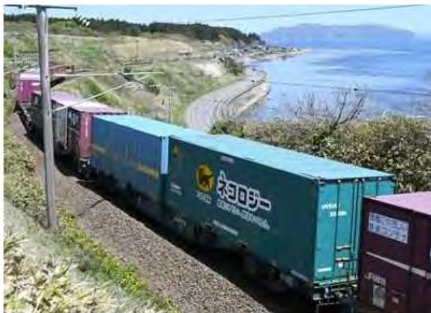
図3.1.14 鉄道を利用した長距離輸送の事例 (31ft コンテナ 2 個搭載事例) (R1.5EHRF 撮影)
