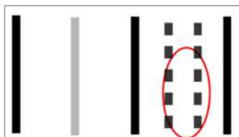
白線かすれ (消えかかり、消し残り)
