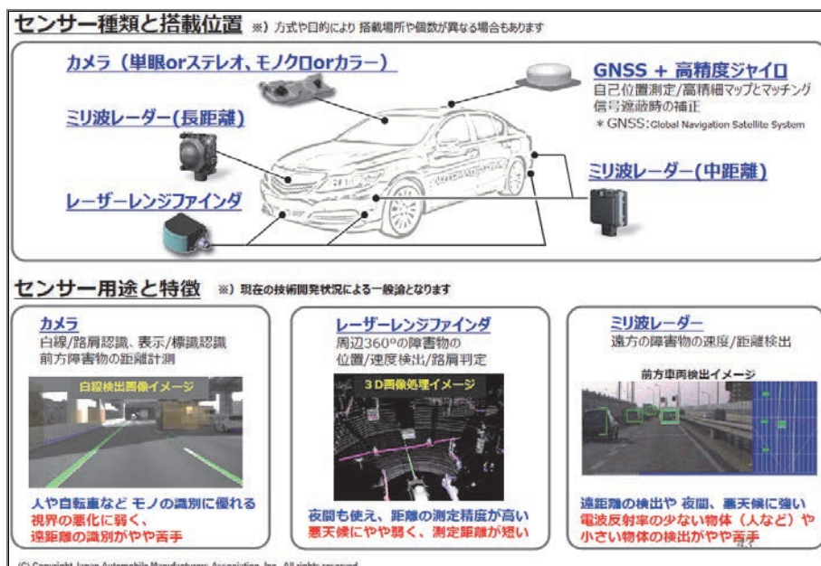
図 2.12 センサー種類と搭載位置、センサー用途と特徴 18
