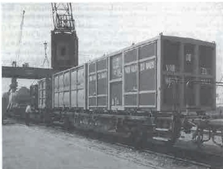
写真4-1：鉄道と道路の相互利用を促進するためのドイツ鉄道の大型コンテナ
