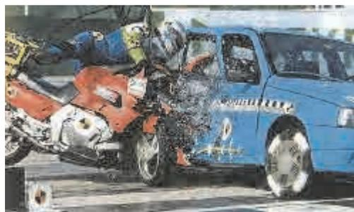
写真 11-9 : オートバイと乗用車の衝突試験
