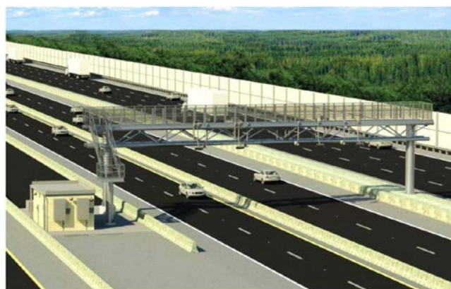
図 参13 Managed Lane の料金収受用ガントリー
