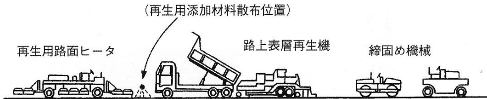
図4.3.2 路上表層再生工法(出典:『写真でみる高速道路の舗装』(財)高速道路技術センター・平成15年3月)
