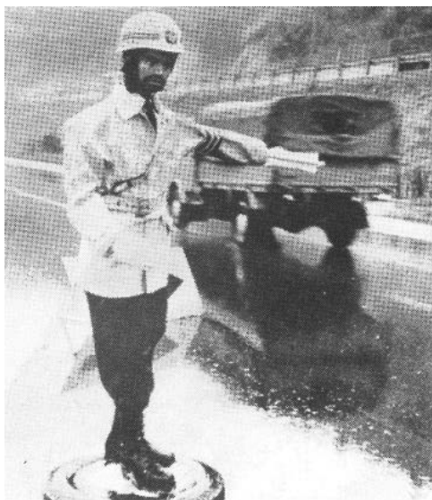
*20 [プラスチック製の旗振りロボット「安全太郎」第一号] (『過去に学ぶ』・(財)高速道路技術センター・平成2年11月)
